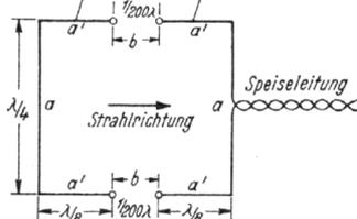
Bild 2. Geknickte Dipol-Richtantenne mit Reflektor und einseitiger Strahlung.
